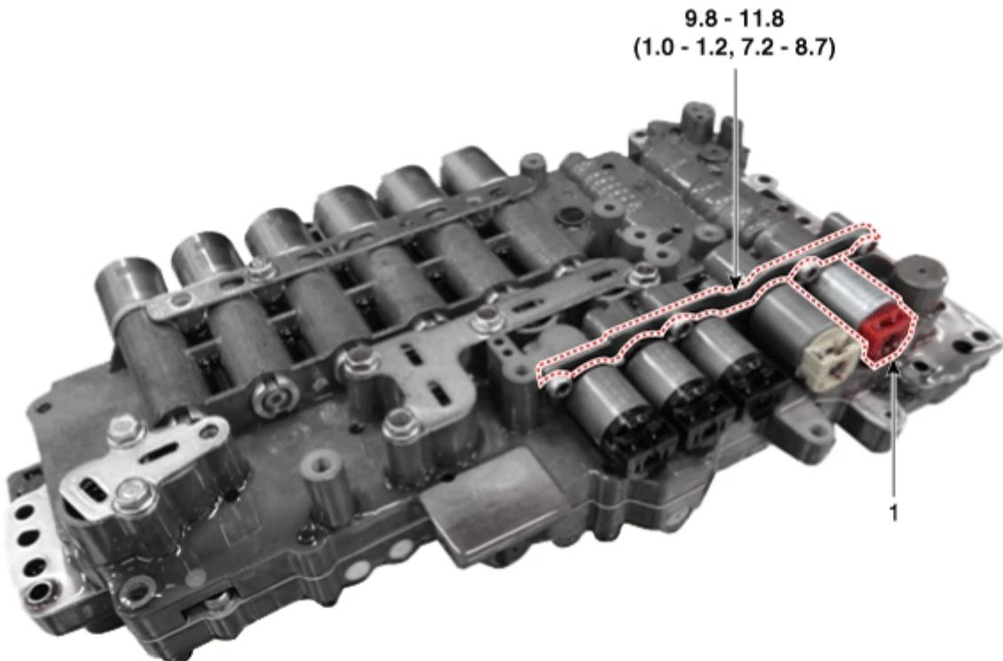
Tightening torque: N·m (kgf·m, lb·ft)
